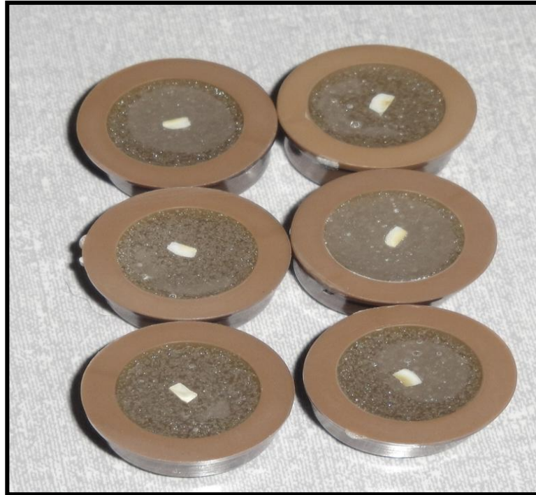
Figura 4 – Blocos de esmalte preparados para o ensaio de microdureza
